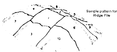
شکل ۶- مواضع نمونه‌برداری از یک تل مخروطی یا مکعب ماده کودی
